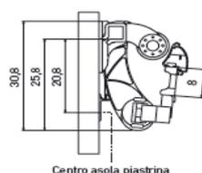
E' composto da un supporto braccio in acciaio alto 31 cm, da un distanziatore in acciaio da 8 cm per il puntale braccio e da una piastrina reggisplinta in acciaio da fissare solo a parete.
